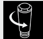
Wykręcanie filtra ze zbiornika wody
